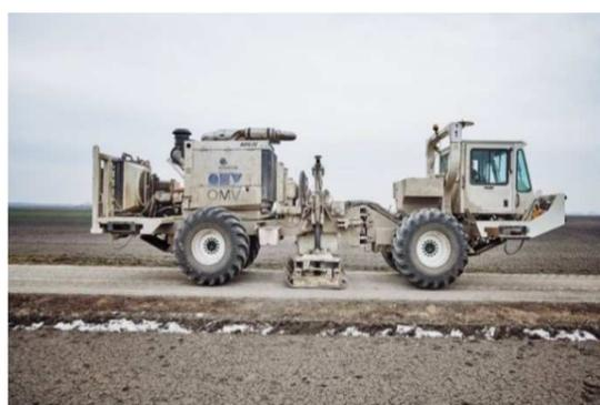
OMV Seismik Messfahrzeug
